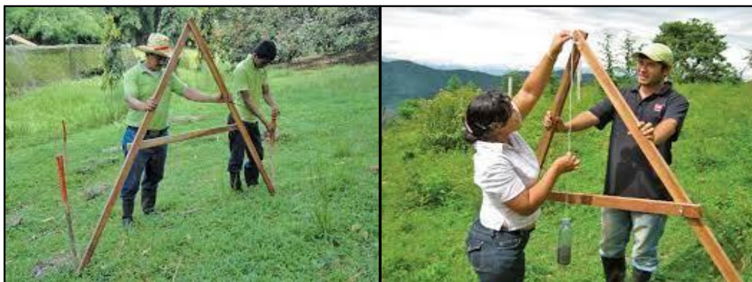
Figura 2.8 Exemplos de marcação de curva de nível com utilização de pé-de-galinha
