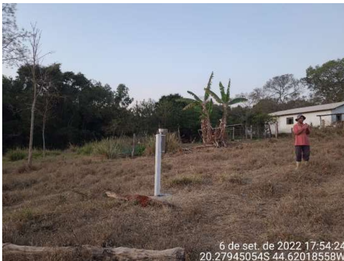
Figura 2.4 Registro do pluviômetro instalado na propriedade.
