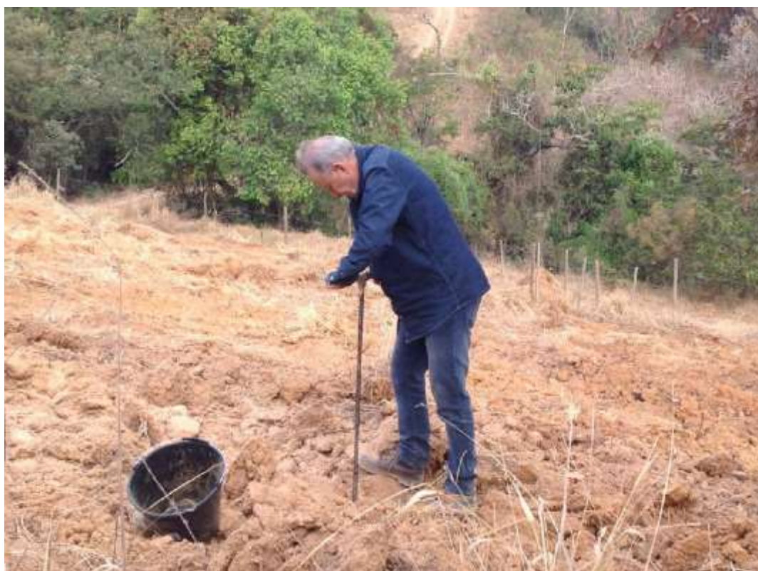
Figura 3.93 Coleta de amostras para análises físico-químicas com trado holandês.
