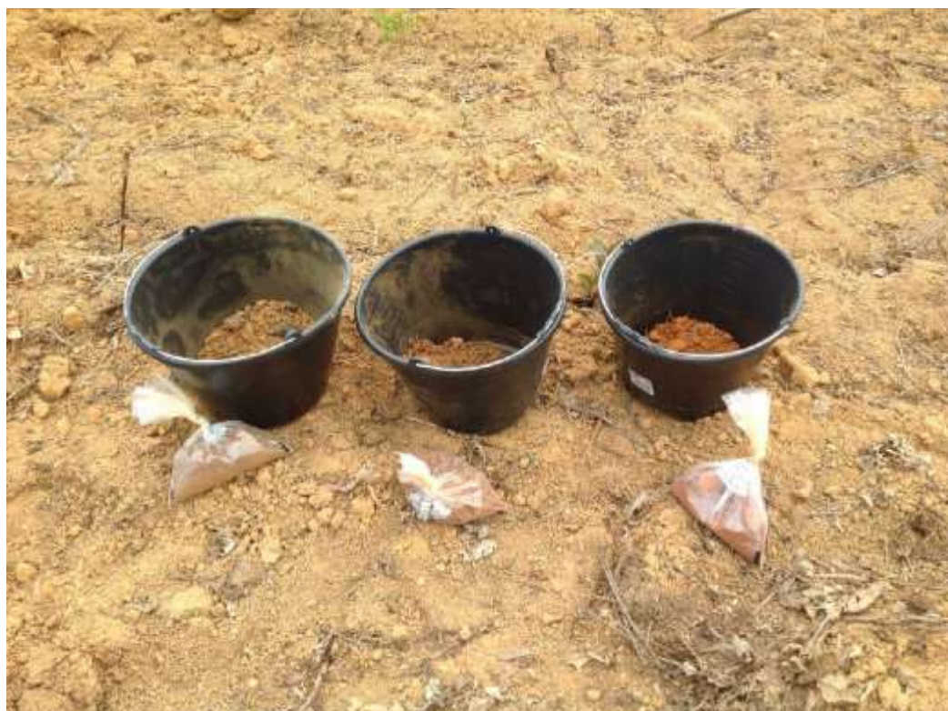
Figura 3.32 Amostras de solos em três profundidades coletadas e ensacadas.
