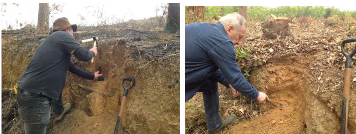
Figura 3.9 Coleta de amostras indeformadas com anéis.
