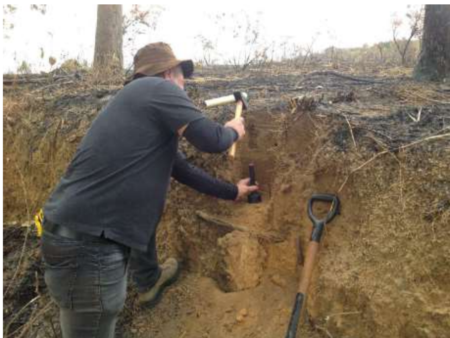
Figura 3.12 Coleta de amostras indeformadas com anéis no PONTO 8.
