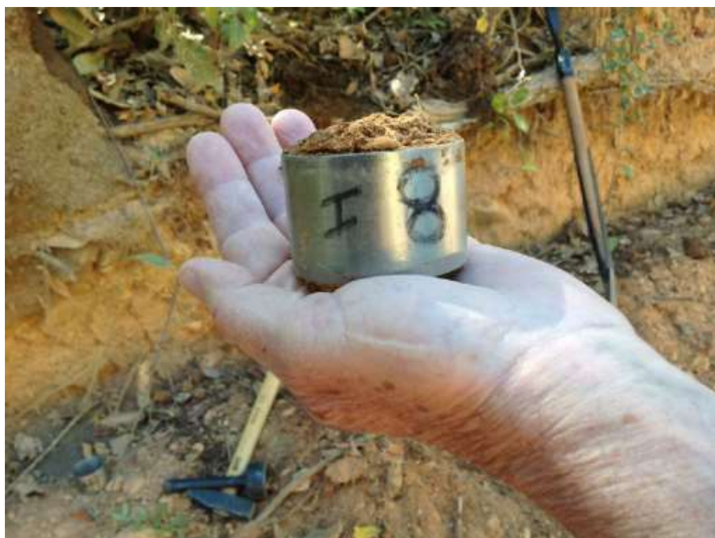
Figura 3.101 Anel volumétrico coletado com amostra indeformada.
