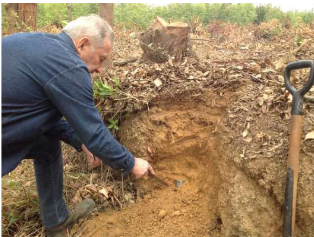
Figura 3.18 Coleta de amostras indeformadas com anéis no PONTO 17
