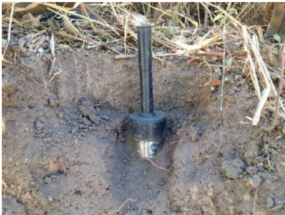
Figura 3.62 Coleta de amostra indeformada no PONTO 54.
