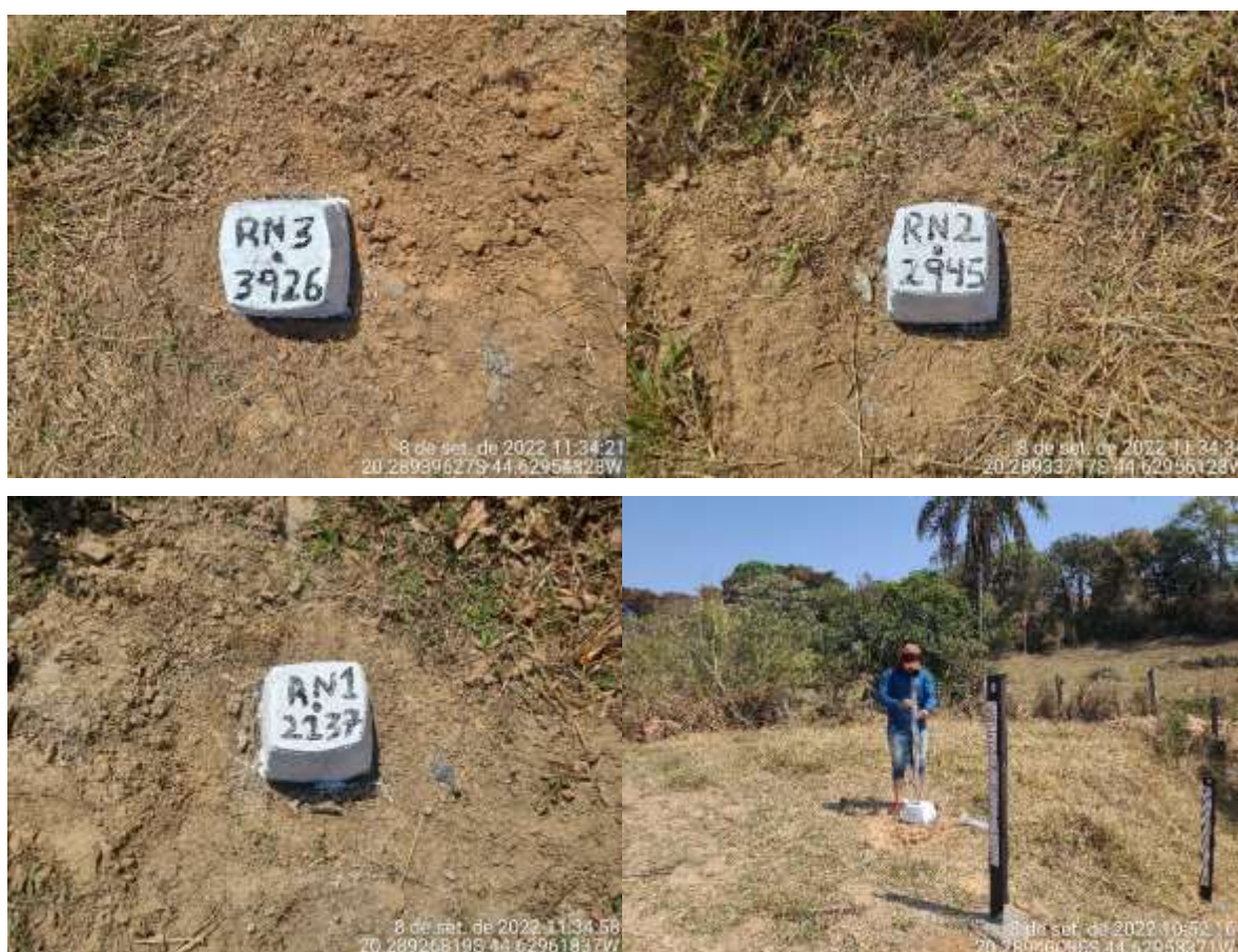
Figura 2.6 Instalação dos RNs na seção monitorada da microbacia do Ribeirão do Sapé.
