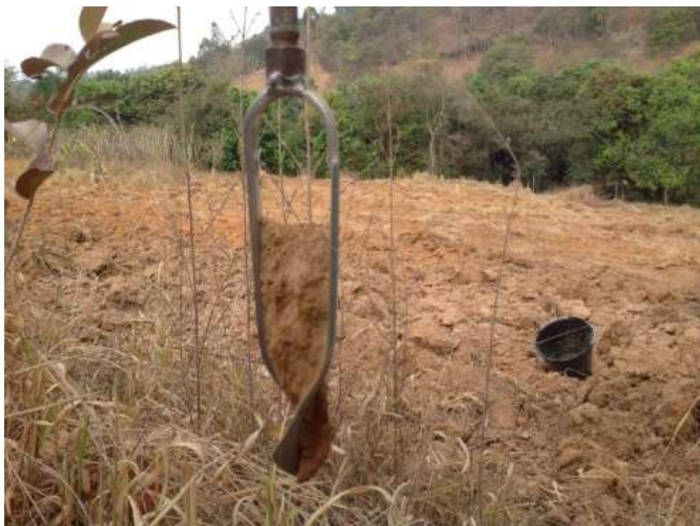
Figura 3.94 Trado holandês com solo coletado.
