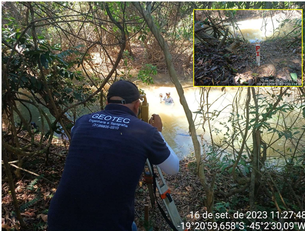
Figura 3.21 – Operação da estação Total no levantamento. No canto superior da imagem está destacado o piquete do início da seção. Fonte: GAMA ENGENHARIA (2023).
