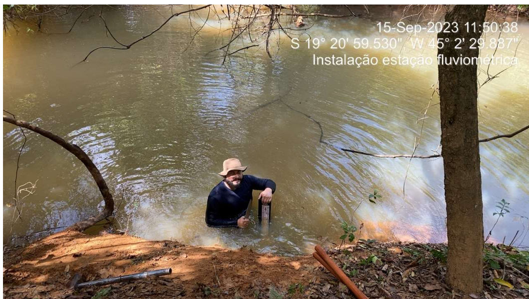
Figura 3.12 – Instalação da primeira régua. Fonte: GAMA ENGENHARIA (2023).
