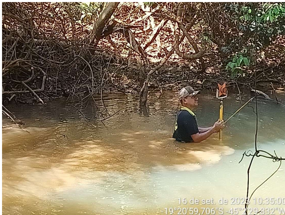
Figura 3.22 – Levantamento na seção molhada. Fonte: GAMA ENGENHARIA (2023).
