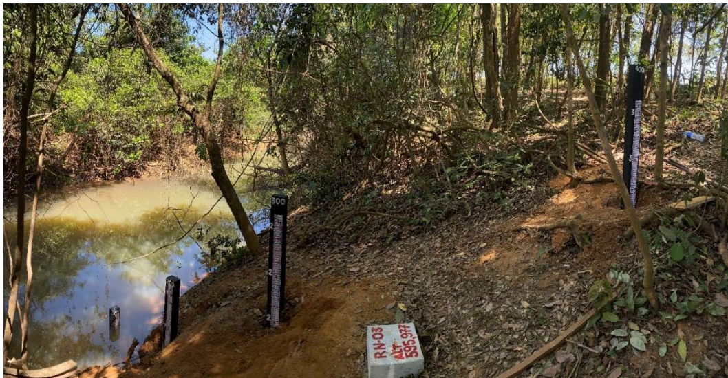
Figura 3.11 – Réguas limnimétricas instaladas. Fonte: GAMA ENGENHARIA (2023).
