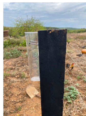
Figura 3.18 – Vista lateral do pluviômetro instalado. Fonte: GAMA
