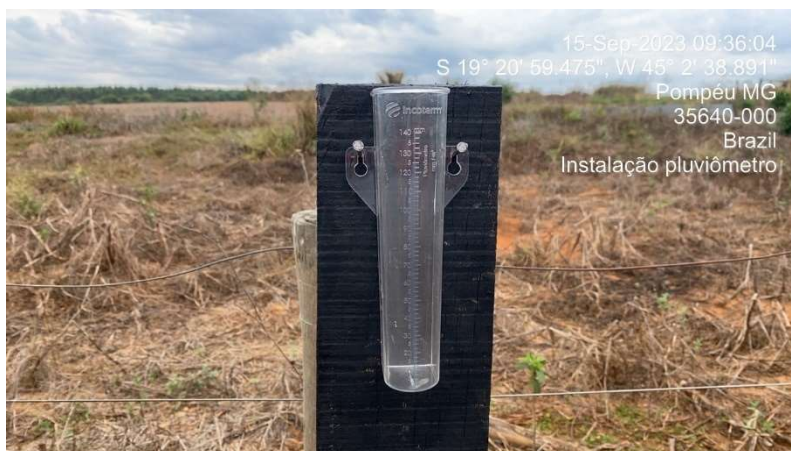
Figura 3.17 – Vista frontal do pluviômetro instalado. Fonte: GAMA ENGENHARIA (2023).
