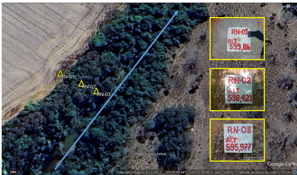
Figura 3.4 – Croqui com a disposição espacial das RNs com destaque do trecho retilíneo em azul, indicando o sentido do fluxo d’água. Fonte: Adaptado de Google Earth (2023).
